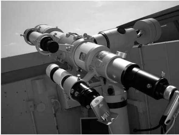
図3 月ライブ光学系。鏡筒は、左の小型望遠鏡から、ファインダー、月望遠鏡、地形望遠鏡である。月望遠鏡、小型望遠鏡の接眼部にウェブカメラを設置して映像を配信している。
