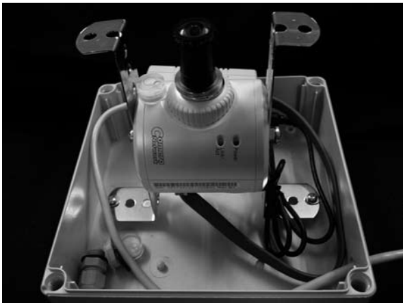
図5 全天ライブカメラ。(左) ネットワークカメラに魚眼コンバータレンズを設置して天頂に向けている。(右) カメラにケースと透明半球をかぶせて設置した状態。
