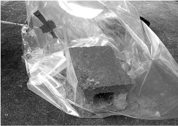
図4. コンクリートブロックの溶解によって放出される二酸化炭素を集気しているようす。
