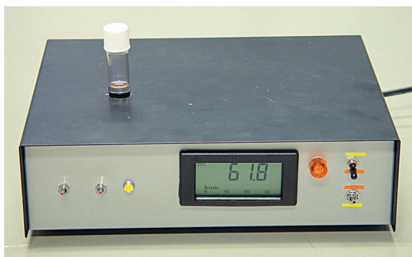
図 1. 試作蛍光光度計
