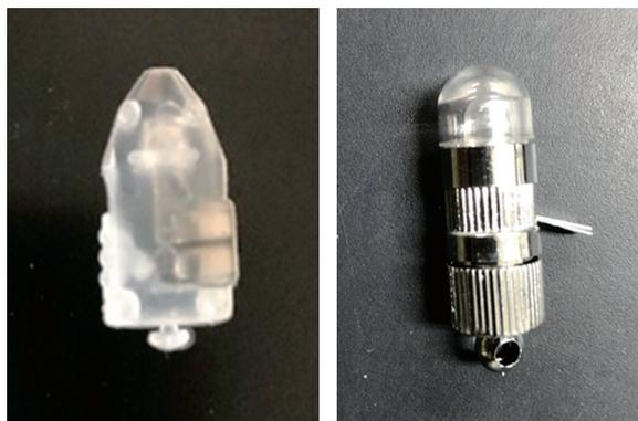
図2. スカイランタン用ボタン電池型LED光源 [10]
