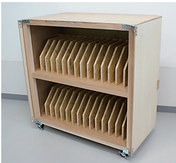
図2 製作した充電保管庫（開けた状態）
