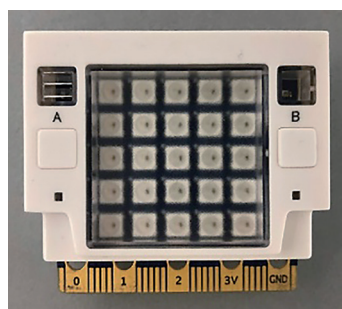
図2 ESP32を使用したマイコンボードと入出力端子
