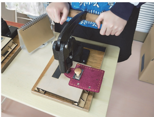
図12 改良したハンドプレス機での作業の様子
