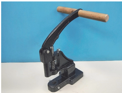
図10 持ち手付きハンドプレス機型補助具
