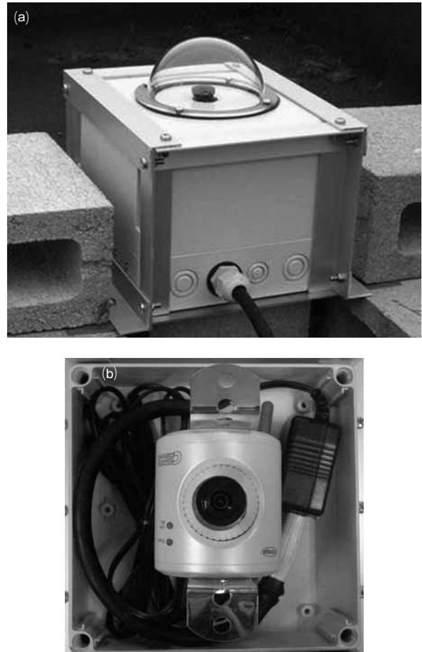
図1 (a)全天ライブカメラ。宮城大屋上に設置。(b)ハウジング内の様子。魚眼コンバータレンズがついたネットワークカメラを天頂に向け設置している。
