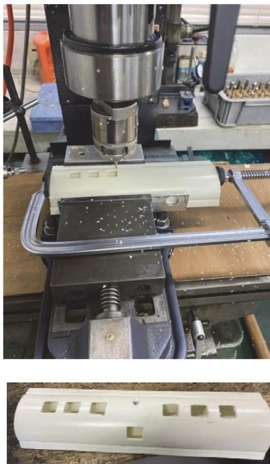
図3 加工作業(2): フライス盤加工
