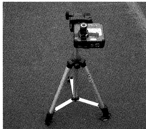
図3 全天カメラを野外に設置した様子。三脚に設置したカメラを天頂に向ける。また、カメラの向きは南北方向にあわせる。
