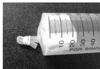
図3 先端のチューブを折り曲げ、輪ゴムで固定する
