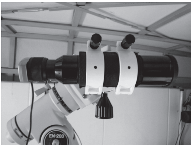
図 7 月の位置撮像システムの光学系と撮像装置
