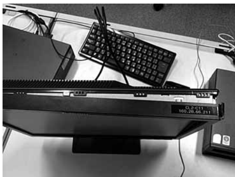
図 2 端末ディスプレイ枠の破損
