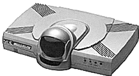
図 1 NEC が発売した ISDN と IP の両方のプロトコルに対応した小型のテレビ会議装置 Mediapoint IP[1]
