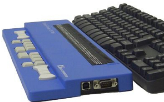
図1 本学に導入される点字ディスプレイ (KGS社製、ブレイルテンダー BT46)
