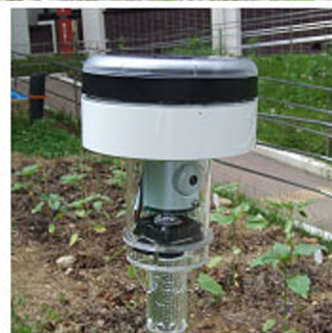
図1 上図: 花壇に設置したフィールドサーバ 下図: フィールドサーバのセンサー部
