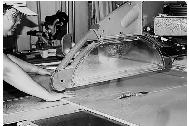
(a) スライドソーによる切断（事前準備）
