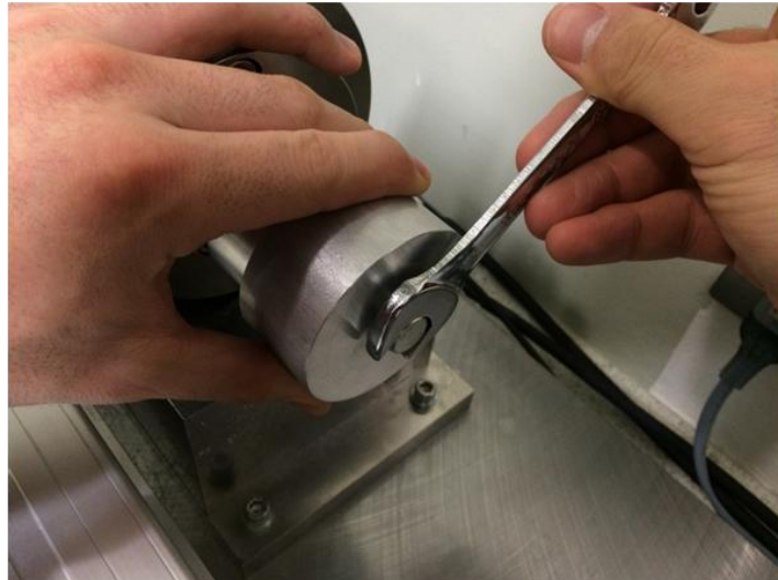
図 5.8 試験片をボルトで固定する
