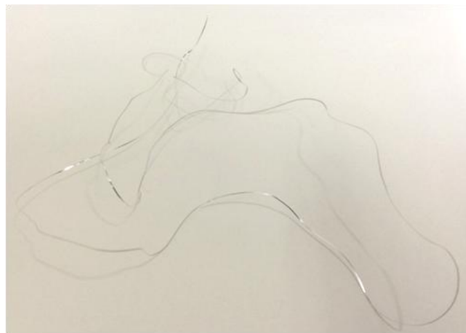
図 5.29 純アルミ切削時の切りくずの形態
