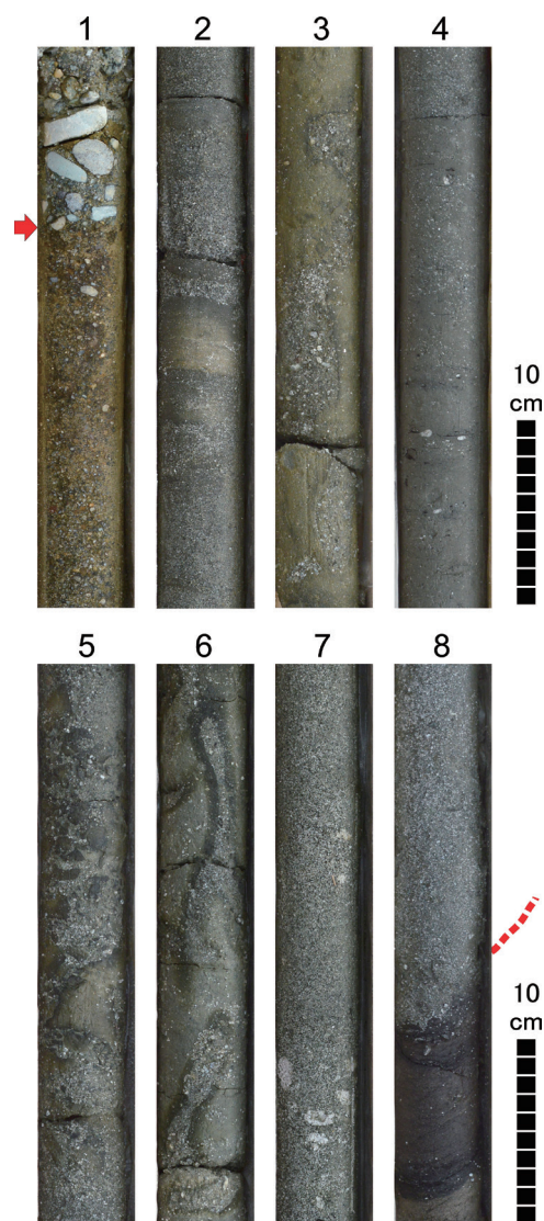
図6 ボーリングコアの竜の口層の岩相
