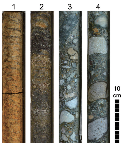
図5 ボーリングコアの沖積層と段丘堆積物層の岩相
