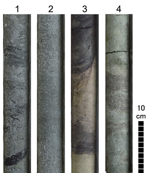
図7 ボーリングコアの亀岡層の岩相
