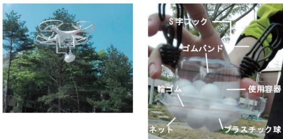
図19 (左). 簡易装置を取り付けたドローン, 図20 (右). 簡易装置を取り付けの概要
