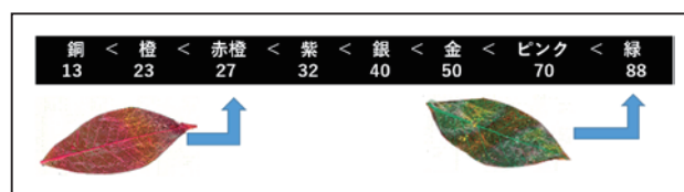
図 2 酸素の銅箔中拡散距離と発色の関係 (数値の単位: \mu\text{m} )
