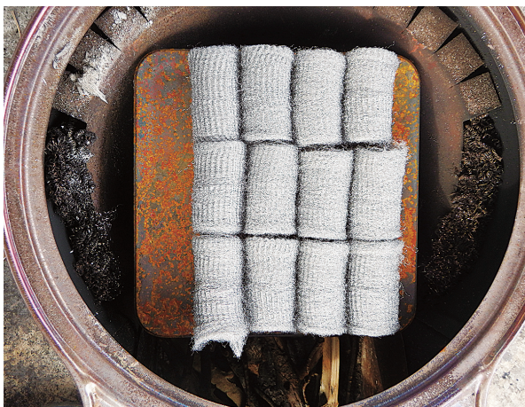
図15. 排煙部に詰めたスチールタワシと炭焼き容器上に設置したスチールウール。スチールウールは炭焼き容器内にも詰めてある。
