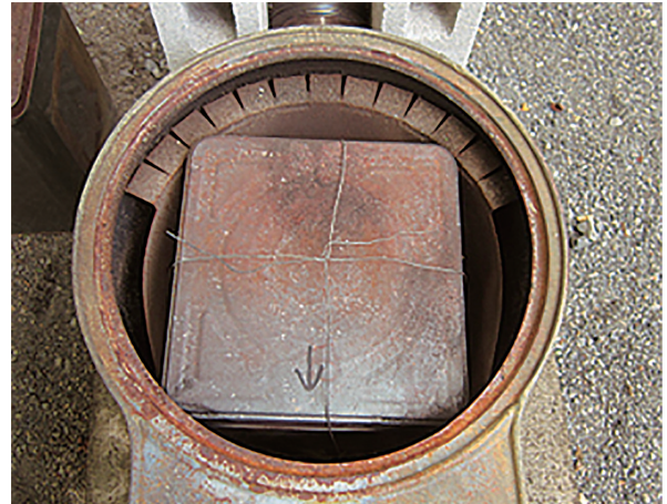
図6. 薪ストーブに充填した炭焼き容器
