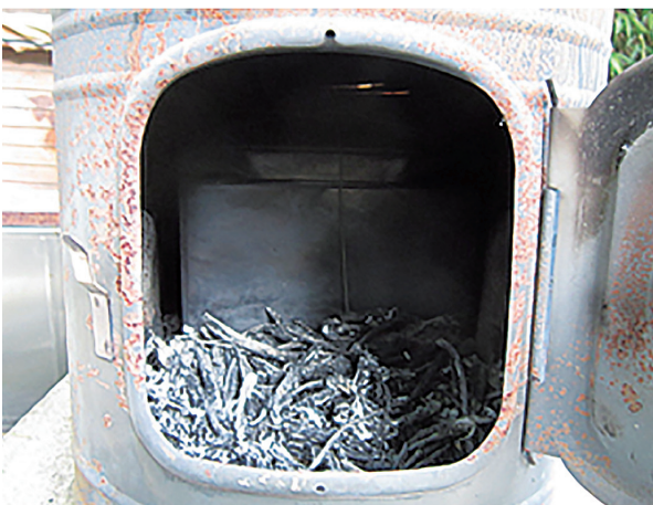
図11. 炭焼き容器取り出し時の薪ストーブ内部
