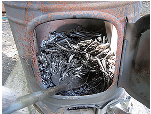
図13. 薪ストーブ内部に残留した炭の取り出し
