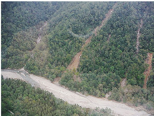
図6. 戸蔦別川本流に面した斜面での表層崩壊
